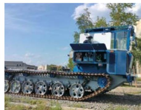
На пятиметровой грузовой платформе УТС-140 может быть также установлено крановое оборудование или емкость с большим количеством воды. Машина развивает скорость до 24 км в час.
